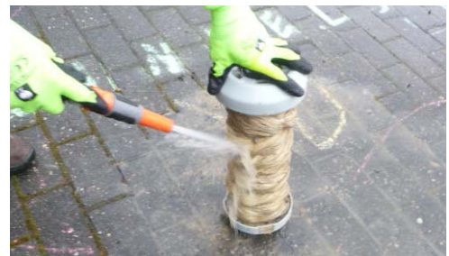
Abb. 7: Spülen der Membranfasern
