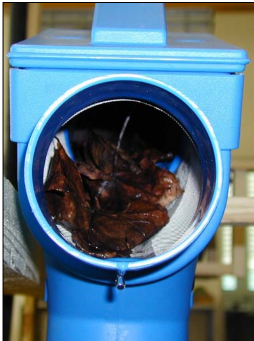
Abbildung 12: (links) 3P Patronenfilter PF mit Q = 0,2 \text{ l/s} und Verschmutzung (Laub)
