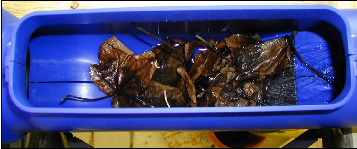
Abbildung 6: INTEWA Wechselsprungfilter WSP100 mit Q = 0,2 \text{ l/s} mit Verschmutzung
