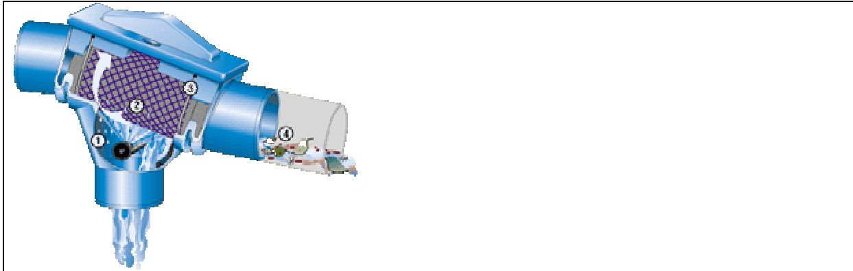
Abbildung 9: Funktionsprinzip der Rückspülautomatik 3P Patronenfilter PF
