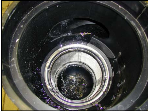
Abbildung 18: (links) WISY WFF-100 mit Q = 0,11/s (zu Beginn des Versuches)
