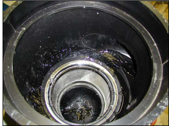
Abbildung 18: (links) WISY WFF-100 mit Q = 0,11/s (zu Beginn des Versuches)
