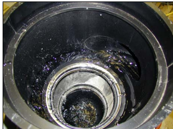
Abbildung 20: (links) WISY WFF-100 mit Q = 0,2l/s (zu Beginn des Versuches)
