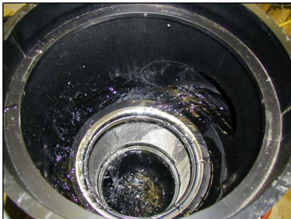
Abbildung 20: (links) WISY WFF-100 mit Q = 0,2l/s (zu Beginn des Versuches)
