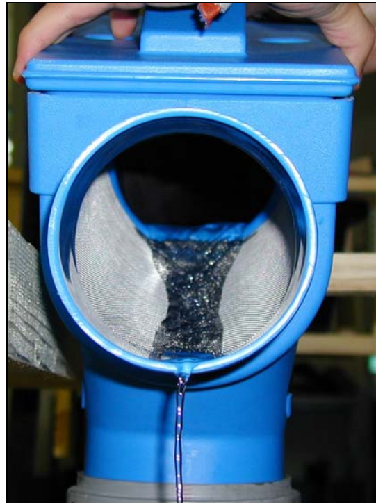
Abbildung 11: (rechts) 3P Patronenfilter PF mit Q = 0,2 l/s (5 sec nach Versuchsbeginn)
