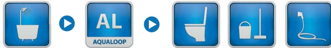
Beim Grauwasserrecycling wird das gering verschmutzte Wasser aus Dusche, Badewanne, Handwaschbecken und ggf. Waschmaschine gesammelt und aufbereitet, um es für Toilettenspülung, Gartenbewässerung und Reinigungszwecke wieder zu verwenden.
