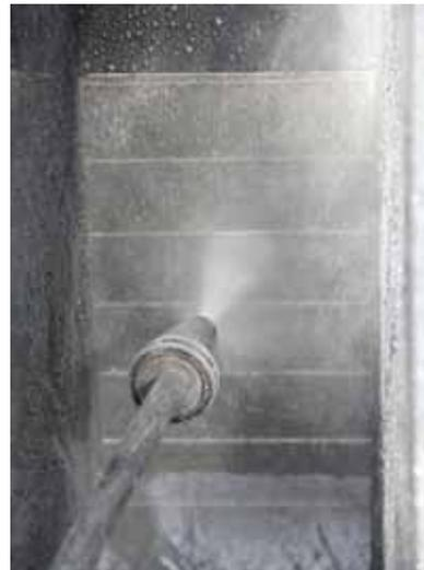
Abb. 16: Siebreinigung mit HD-Reiniger
