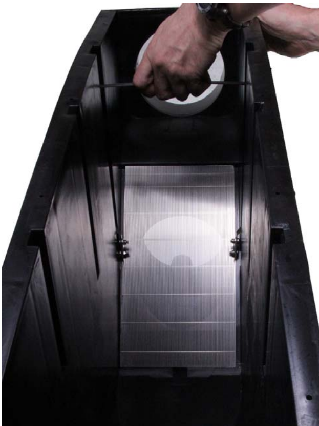
Abb. 25: Entnahme des PR150-Siebes
