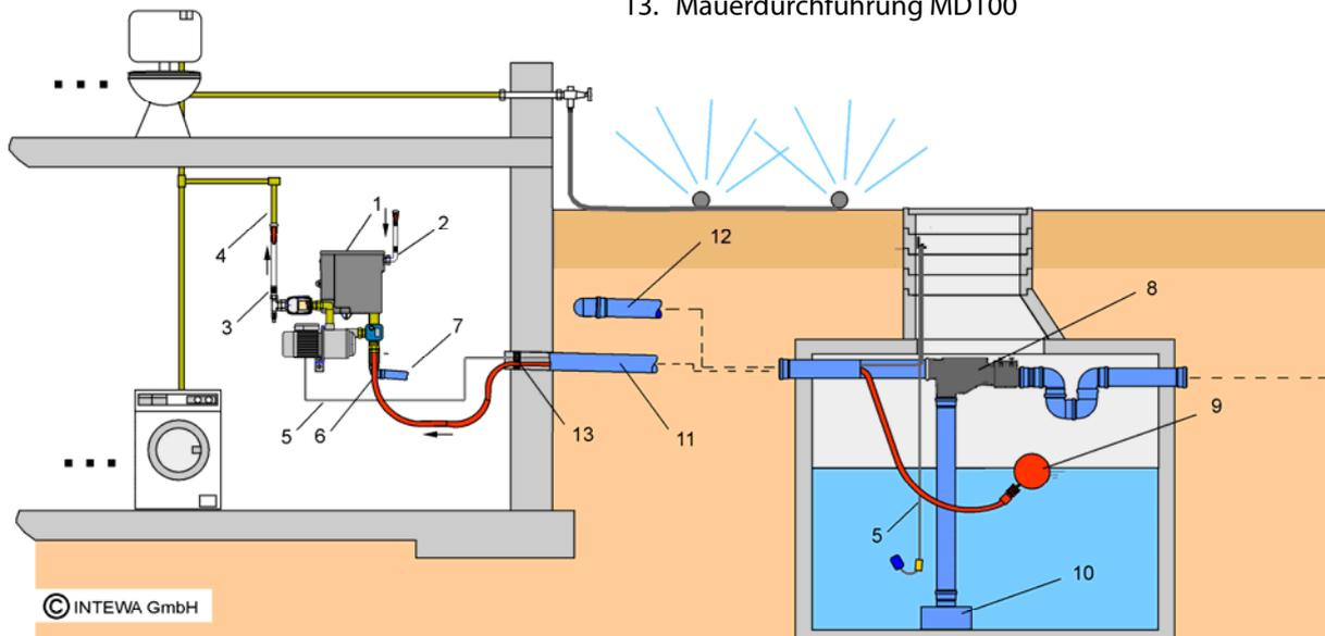
Beispielübersicht einer Regenwassernutzungsanlage mit Erdspeicher
