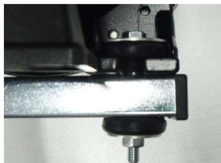
Mit dem beiliegenden Montage-Sechskant wird die Ventileinheit mit dem Behälter verschraubt.
