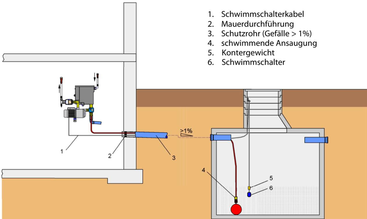
Das Schwimmschalterkabel wird bei unterirdischen Speichern durch das Schutzrohr zum RM Favorit-A geführt. Hierzu muss es von der Basissteuerung abgeklemmt werden. Dann wird die Kabelverschraubung auf das Kabel geschoben.
