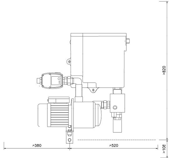
Die Pumpe des *RM Favorit-A* wird mit dem beiliegenden Wandwinkel an der Wand montiert.
