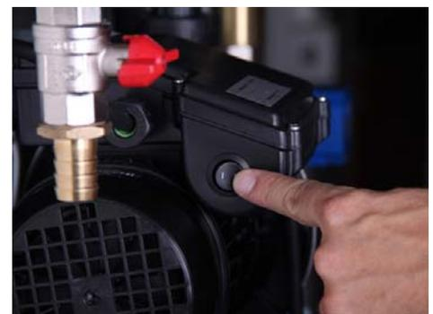
2. Druckabsperrhahn schließen.
