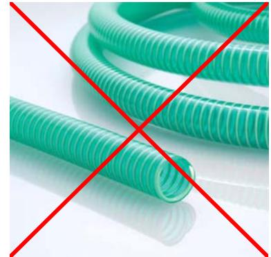
Im Ansaugbereich dürfen keine Flexschläuche eingesetzt werden, da der weiche, innere Gummischlauch sich bei Unterdruck zusammenzieht.
