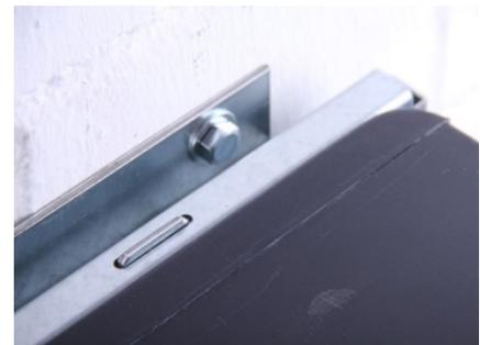
Die mitgelieferten Gummipuffer werden rückseitig in die unteren Ecken der Metallrückwand eingeschraubt. Mit den Gummipuffern liegt das Gerät an der Wand an. Durch unterschiedliche Eindrehtiefen können Unebenheiten der Wand ausgeglichen werden.
